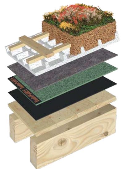
Bauder Schrägdachbegrünung Dachneigung 15–25°
